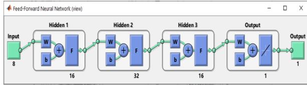
Figure 11. ANN architecture for the concrete compressive strength dataset (*Beton basınç dayanımı veriseti için YSA mimarisi*).
