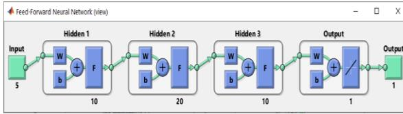
Figure 2. Architecture of the ANN for optical interconnection network dataset (*Optik enterkonktekte ağ için YSA mimarisi*).
