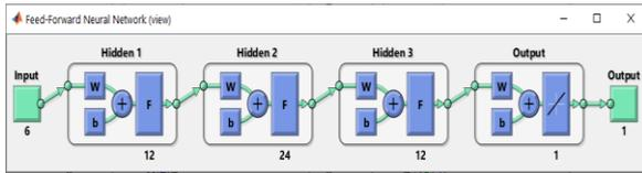
Figure 5. ANN architecture for the Auto MPG dataset (Oto MPG veriseti için YSA mimarisi).
