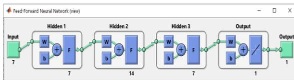
Figure 8. ANN architecture for the energy efficiency dataset (*Enerji verimliliği veriseti için YSA mimarisi*).
