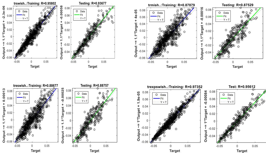
Figure 12. Neural regression plots with the Swish, Mish, E-Swish and Exp-Swish AFs, respectively, for the concrete compressive strength dataset (*Beton basınç dayanımı veriseti için Swish, Mish, E-Swish ve Exp-Swish AF'ları kullanan sinir ağlarının regresyon eğrileri*).
