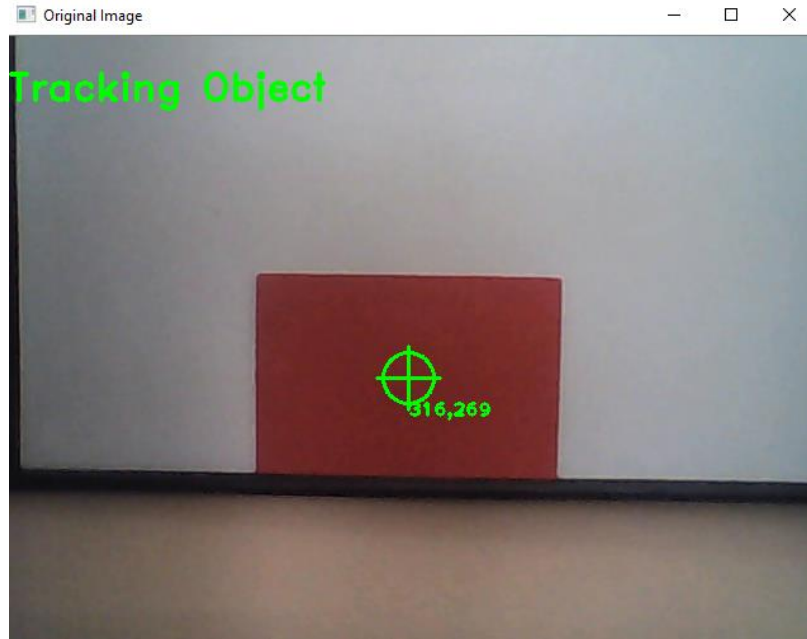
Figure 6. Analysis of the HSV values resulted in the filtered region in the original image ( HSV değerleri analizi sonucu orijinal görüntüde filtrelenen bölge )
