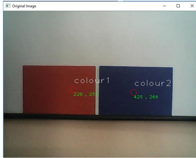
Figure 7. Detection of objects with HSV values ( HSV değerleri verilen objelerin yakalanması )
